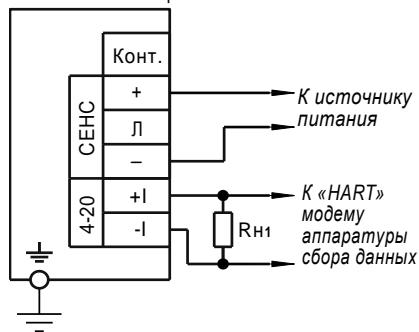
в) Схема подключения по токовому выходу 4-20 мА (протокол HART)
