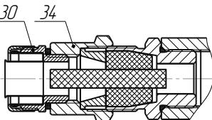
Рис.5 Кабельный ввод с устройством крепления бронированного кабеля
