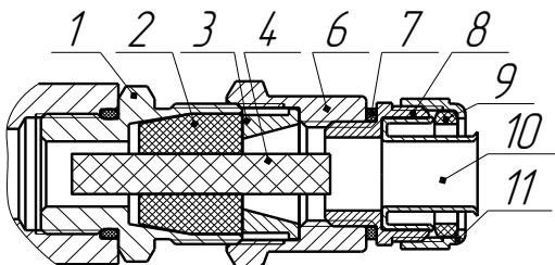
б) кабельный ввод с устройством крепления металлического рукава
