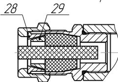
Рис.6 Кабельный ввод с устройством крепления трубы
