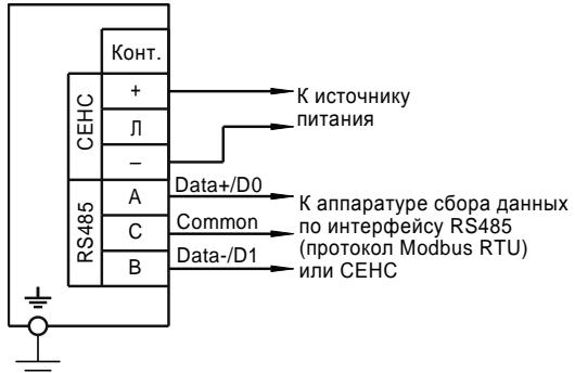
б) Схема подключения по интерфейсу RS-485 (протокол Modbus RTU или СЕНС)
