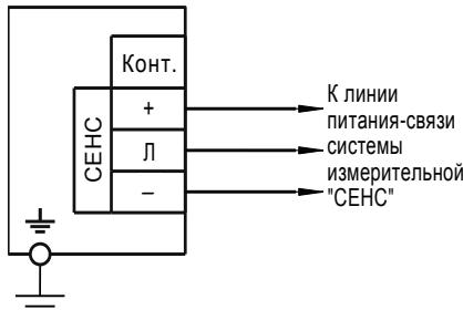
а) Схема подключения по интерфейсу СЕНС (протокол СЕНС)
