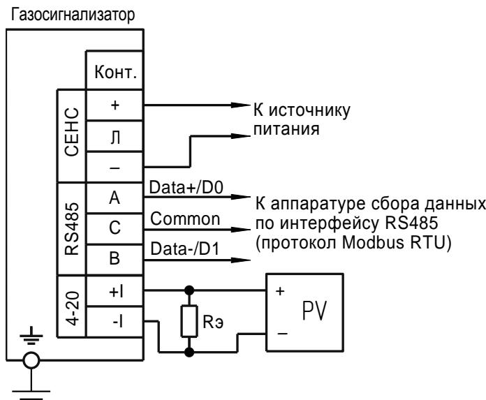
PV – цифровой мультиметр в режиме измерения напряжения;
