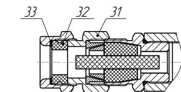
Рис.7 Кабельный ввод с герметизированным устройством крепления бронированного кабеля
